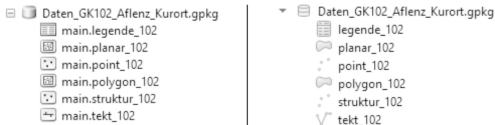
Abb. 1: Struktur des mitgelieferten Datensets (links in ArcGis, rechts in QGis dargestellt)
